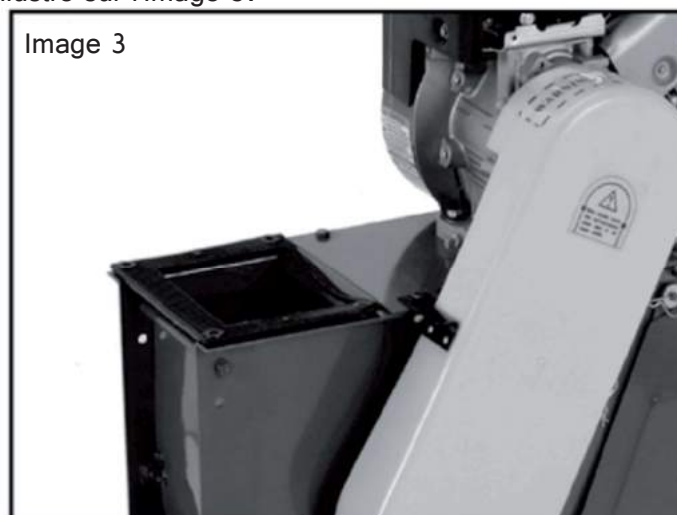
Image 3: Positionnement du joint de la trémie
