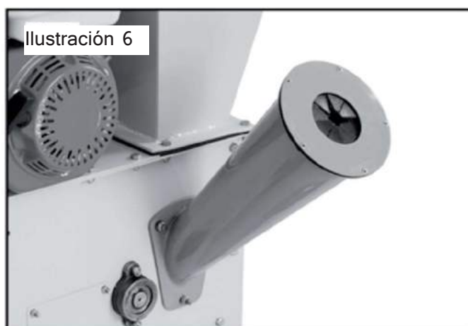
Ilustración 6. Instalación del embudo
