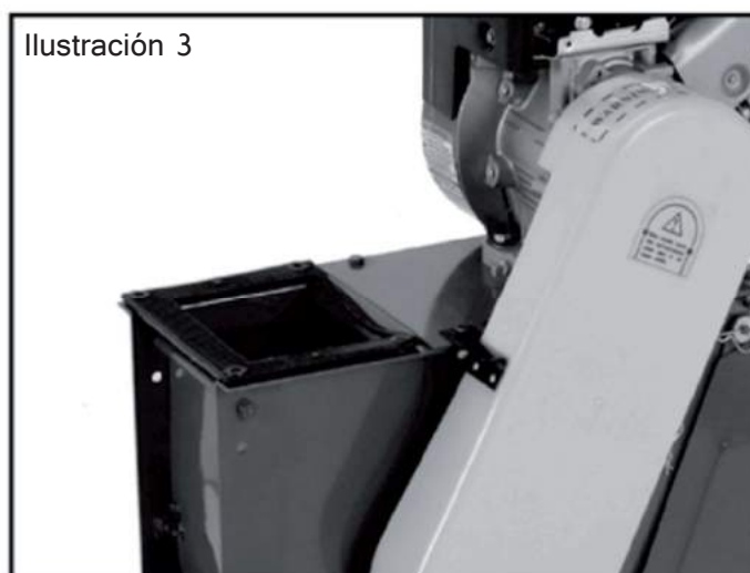
Imag. 3: Posicionar a junta da tremonha
