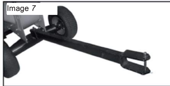
Image 7: Fixation de la barre d'attelage
