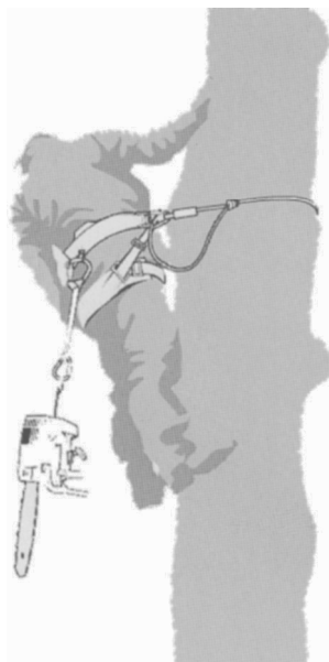
A.2 — Ejemplo de anclaje en la zona central posterior en el arnés.
