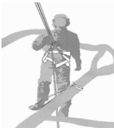
A.4 — Ejemplo de un apoyo de pie temporal a partir de una eslinga sinfín.
