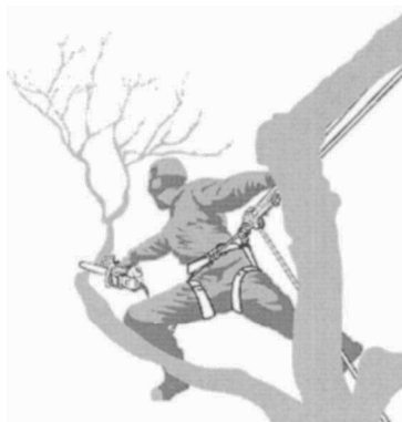
A.5 – Ejemplo de uso de la motosierra con una mano.
