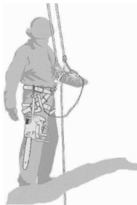
A1 — Ejemplo de conexión de la motosierra al arnés para subir a un árbol
