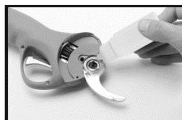
6. Al reemplazar las cuchillas, se debe agregar aceite lubricante entre las cuchillas.
