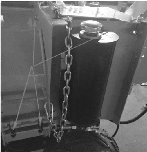
Ao afrouxar esses 4 parafusos, você pode abrir a câmara para verificar a condição das lâminas e dos ventiladores.
