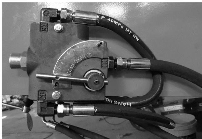
La barra può regolare la velocità di rotazione del rullo di alimentazione (da 0 a 600 RPM).
