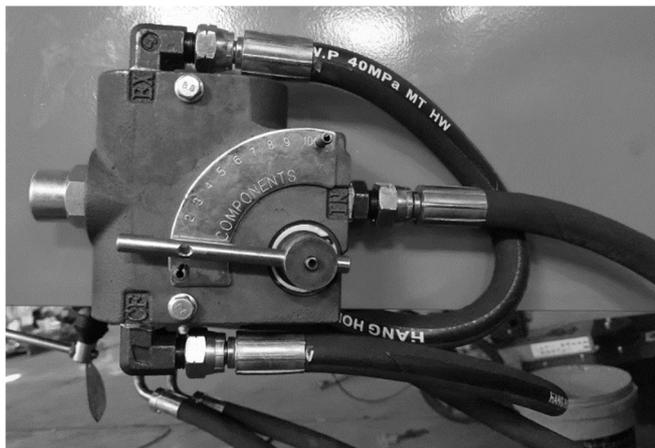
La barre permet de régler la vitesse de rotation du rouleau d'alimentation (de 0 à 600 RPM).
