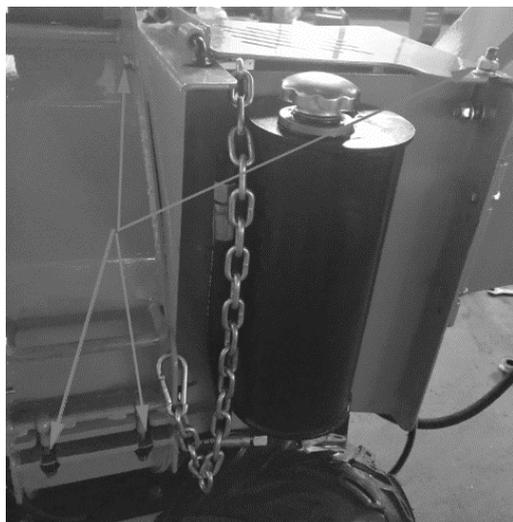
Al soltar estos 4 pernos, puede abrir la cámara para verificar el estado de las aspas y los ventiladores.
