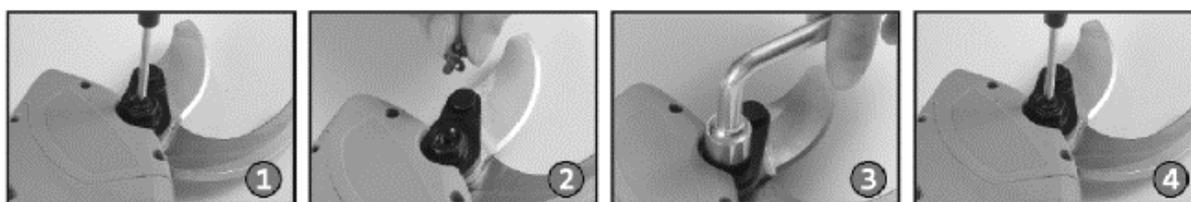
**Controllare l'adattamento della lama ogni mattina prima dell'uso. La lama correttamente tesa non oscillerà da un lato all'altro. Se la tenuta della lama è normale, le forbici risparmieranno lo sforzo durante il taglio.**
