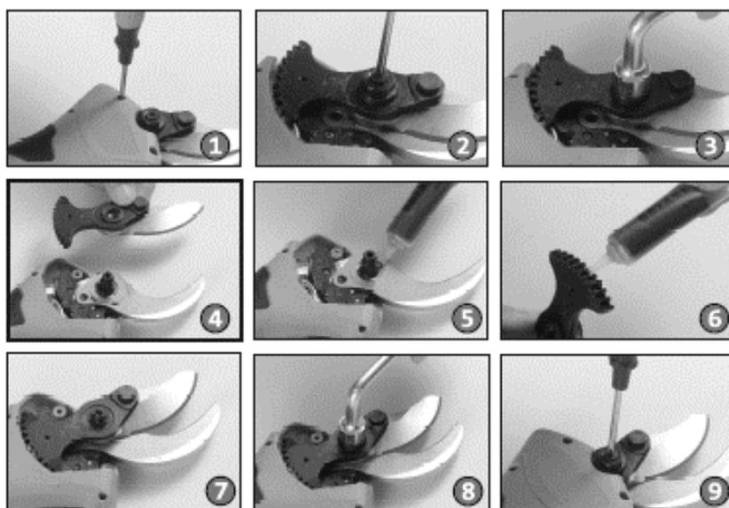
1. Remova os parafusos com uma chave de fenda e abra a tampa. 2. Remova os parafusos do retentor da porca da lâmina (esta etapa é importante) 3. Remova a porca da lâmina
