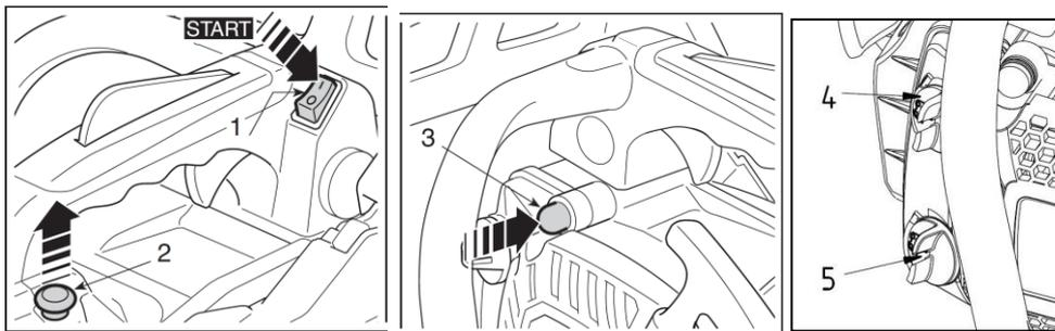
Desenrosque y retire la tapa del combustible y la tapa de aceite. Llene el depósito de combustible y el tanque de aceite al 80% de la capacidad total. Fije el tanque tapa de combustible y aceite en forma segura y limpie cualquier derrame de combustible alrededor de la unidad. Ponga el interruptor en la posición "I". Tire para arrancar.
