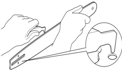
Cuando desmonte la espada, retire el aserrín en la ranura de la barra y la entrada de engrase. Engrase el piñón de la espada.
