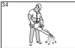
Compruebe la lubricación de la cadena cada tercera carga de la batería. Apunte la punta de la barra a una superficie de color claro a unos 20 cm (8 pulgadas) de distancia. Después de 1 minuto de marcha a 3/4 de aceleración, debería ver una línea distinta de aceite en la superficie de la luz. (Figura 34)
