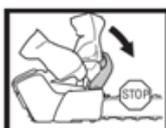
8 Antes de mover la motosierra, apáguela y bloquee la cadena con el freno de cadena. Lleve la motosierra con la barra y la cadena apuntando hacia atrás. Coloque una protección en la barra antes de transportar la motosierra o cargarla en cualquier distancia.
