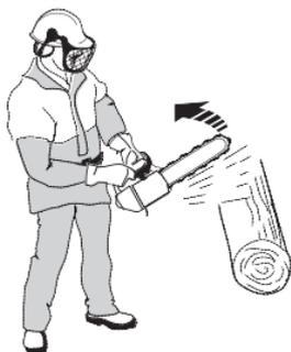
El contragolpe siempre ocurre en el plano de corte de la barra. Normalmente, la motosierra y la barra se lanzan hacia atrás y hacia arriba hacia el usuario. Sin embargo, la motosierra puede moverse en una dirección diferente dependiendo de la forma en que se estaba utilizando cuando la zona de retroceso de la barra tocó el objeto.
