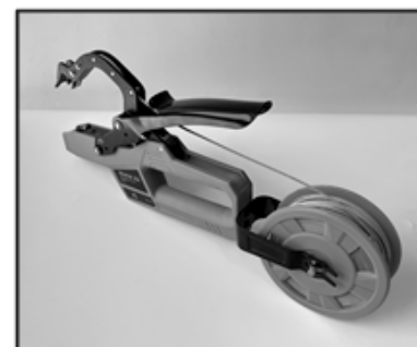
6. Après l'installation, les pinces à lier sont prêtes pour utiliser.
