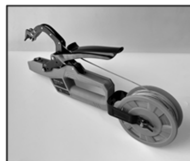
6. Después de la instalación, la atadora está lista para usar.
