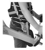
Suelte el cinturón: Puede soltar el cinturón tirando de la placa de plástico del cinturón de la derecha (como abajo) hasta que el pasador de bloqueo salga y saque el pestillo del lado izquierdo, el cinturón se liberará.
