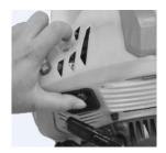
2. Ajuste la palanca del cebador a la posición (off).
