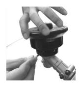
**Suelte la cabeza de corte de nylon.** Utilice un destornillador para sujetar la brida y luego gire la cabeza de corte de nylon en el sentido de las agujas del reloj hasta que esté bien fija, será reemplazada.
