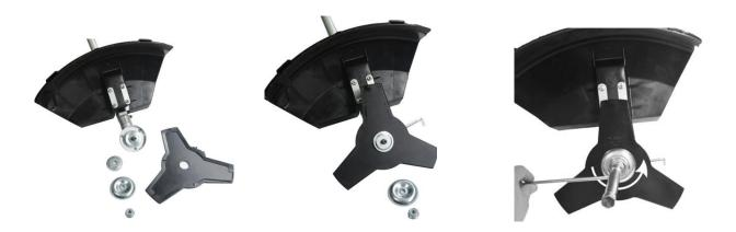
**Libere la cuchilla.** Utilice un destornillador para sujetar la brida y la tuerca de liberación, la cuchilla puede despegarse.
